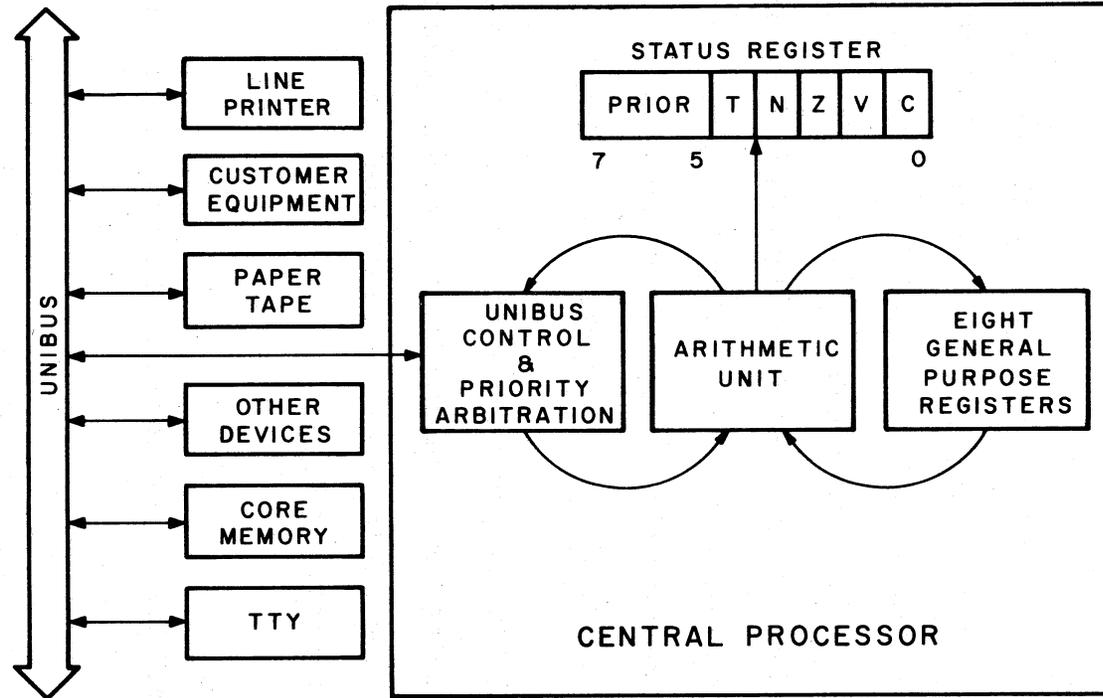
Figure 1-1. PDP-11 SYSTEM BLOCK DIAGRAM
